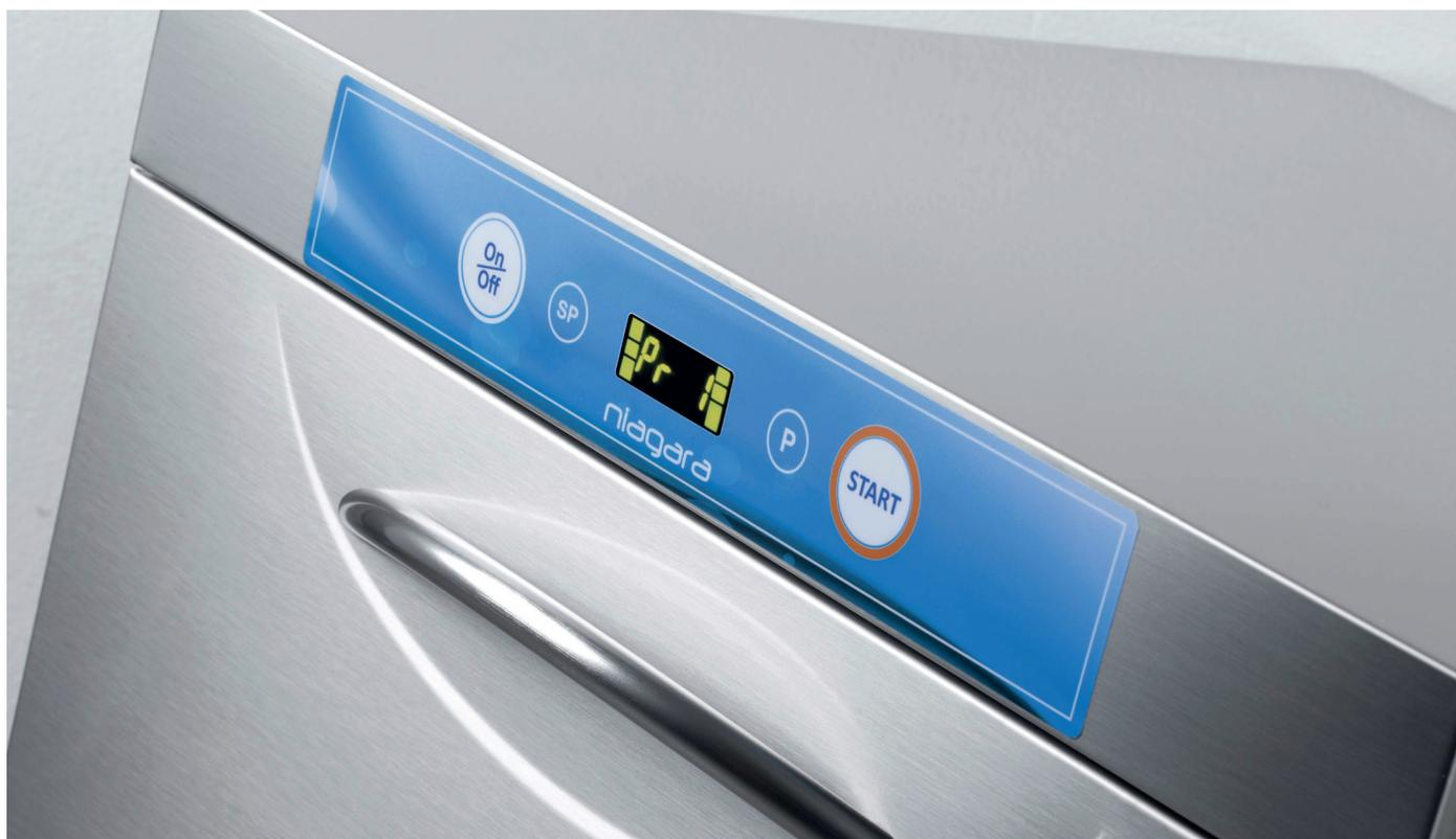
Mit 4 Bedientasten und einem großem LED-Display mit zwei seitlichen Statusbalken ist eine einfache, verlässliche und komplette Bedienung möglich. Durch die Verbindung von Farbe und Symbolen erkennt man auf einem Blick den Spülstatus. Zusätzlich werden Betriebsparameter wie Tank- und Boilertemperatur oder die Anzahl der Spülgänge, sowie Informationen des automatischen Diagnosesystems angezeigt.
